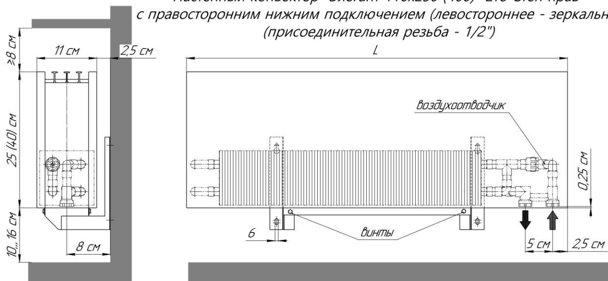
Настенный конвектор "Эlegant 110x250 (400) -2то Терм Стен прав" с нижним подключением (левостороннее - зеркально) и встроенным термоклапаном (присоединительная резьба - 1/2")
